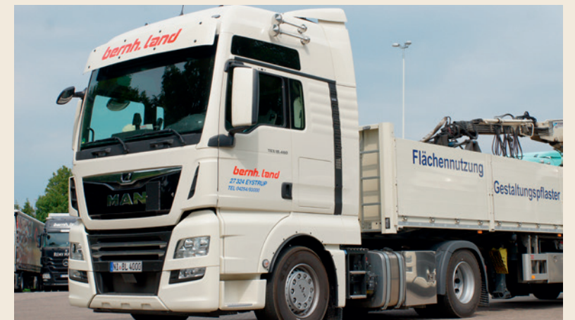
Die vertrauten Baustoffauflieger der Marke Pacton erhielten ebenfalls neue Zugeinheiten. Interessant ist der eigens verkleinerte zusätzliche linke Tank vor dem Staukasten.
